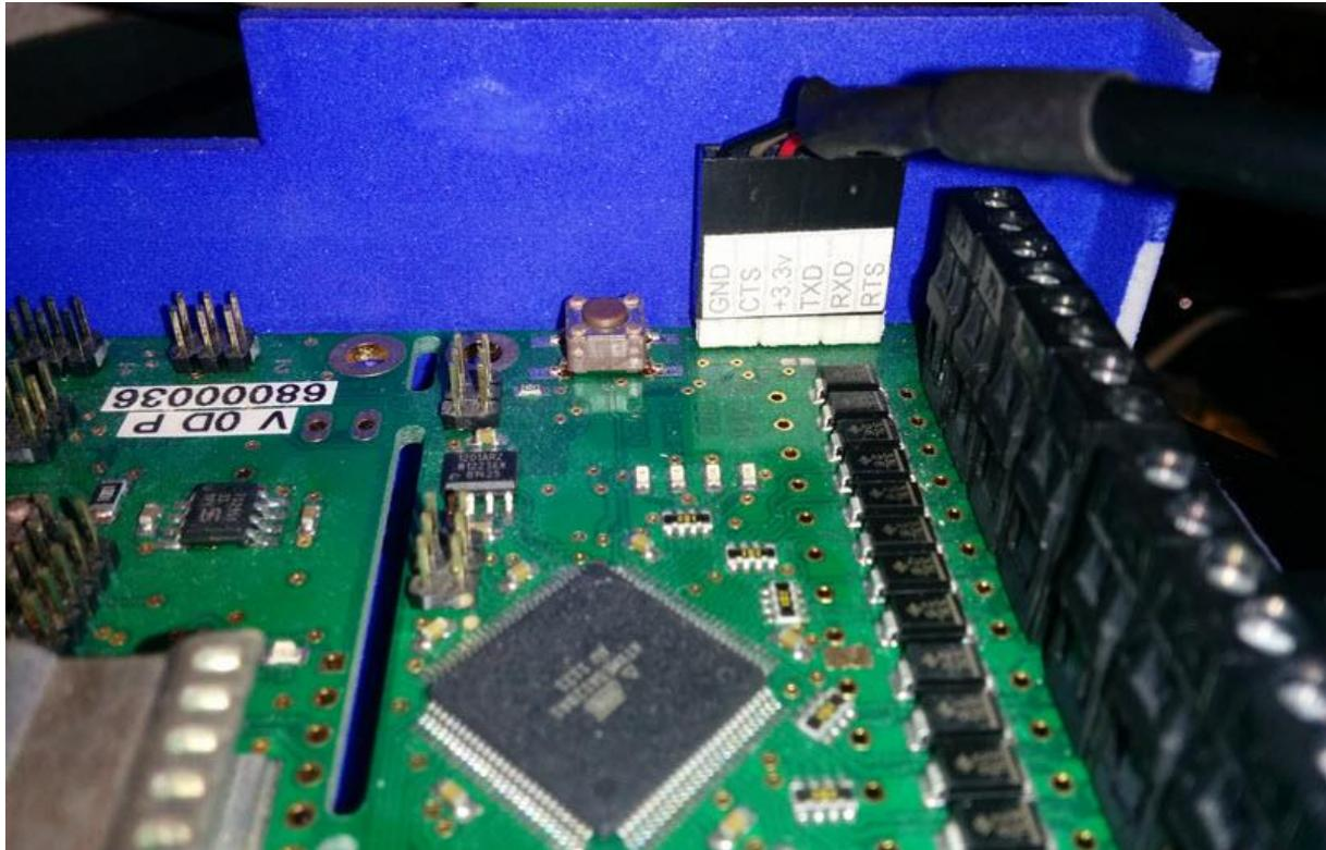
**Bild 14:** Gestecktes FTDI Kabel am GBM 16T<sup>7</sup>
