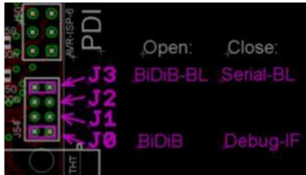
**Bild 05:** Bild zum Stecken der Brücke für Jumper J3<sup>2</sup>
