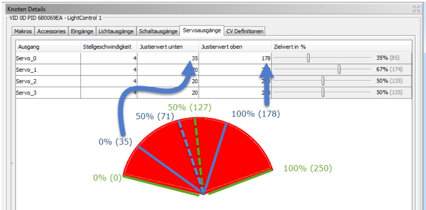
Ein Servo hat einen Stellbereich (der rote Bereich). Dieser Bereich ist der maximale Bereich der mit der LC angesteuert werden kann. Dabei ist der Justierwert unten = 0 und der Justierwert oben = 250.
