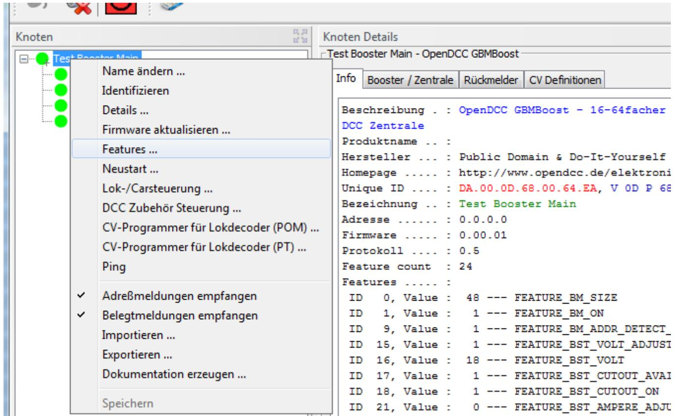
In der Spalte Wert kann der aktuelle Wert geändert werden. Durch Klick auf **Speichern** werden die angepassten Werte auf den Knoten übertragen.
