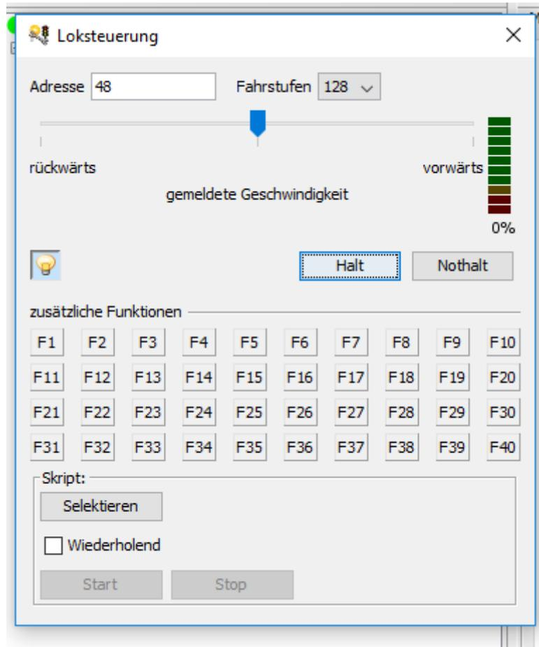
Falls ein Dekoder einen Wert für „Behälter 1“ mit der DYN\_STATE-Meldung zurückliefert, wird dieser Wert in der Balkenanzeige am rechten Rand angezeigt.
