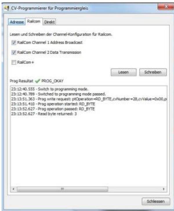
Ein schnelles editieren der wichtigsten Railcom-Einstellungen eines Lokdecoders ermöglicht das Fenster „Railcom“.
