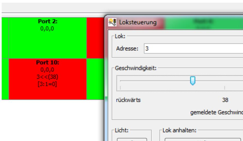
Im Bild oben ist der Decoder 3 im Prüfstand angeschlossen, darum kommt immer 1=0 (also keine fehlerhaften Pakete) aber es kann dort auch ein anderer Wert kommen wenn man auf der Anlage fährt.
