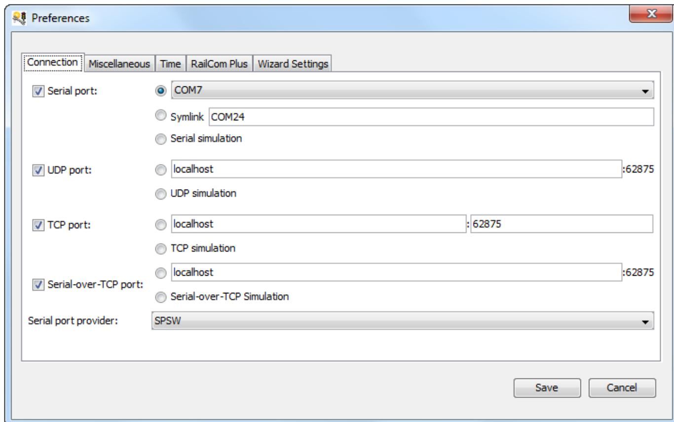
Neben der Auswahl der Schnittstelle kann der verwendete Treiber für den Seriellen Port ausgewählt werden. Hier stehen „RXTX“, „SCM“ und „SPSW“ zur Verfügung. Standardmässig wird RXTX verwendet.
