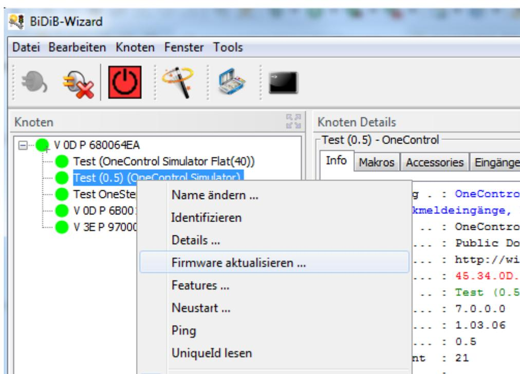
Im *Update firmware*-Dialog wird das Zip-File mit der Firmware für den Knoten ausgewählt. Anschliessend werden die verfügbaren Firmware-Pakete in einem Baum dargestellt.
