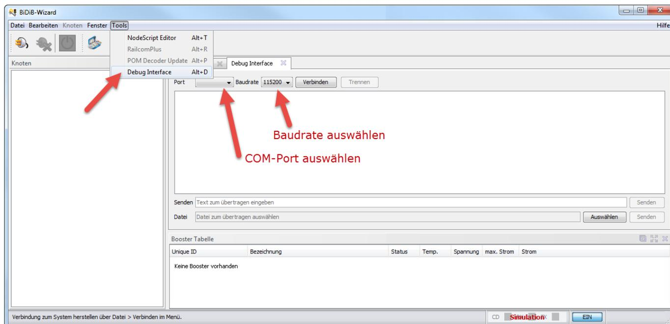
Anschliessend wird der Port über 'Verbinden' geöffnet. Durch Eingabe von '?' wird in den meisten Fällen eine Information des Knotens angezeigt.
