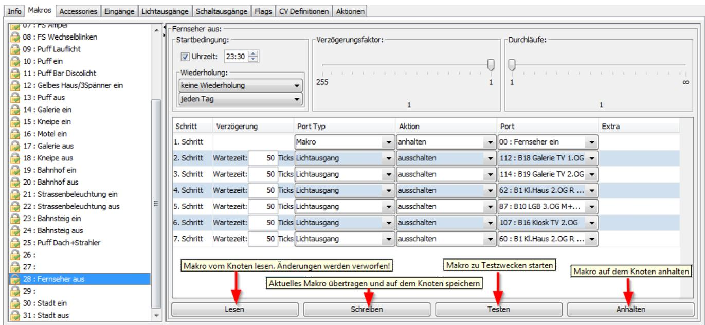
Ein Makro muss auf den Knoten übertragen werden, bevor es genutzt werden kann. Jetzt kann man es testen und erproben. Erst nach permanenter Speicherung ist es dauerhaft auf dem Knoten abgelegt und steht beim Neustart zur Verfügung.
