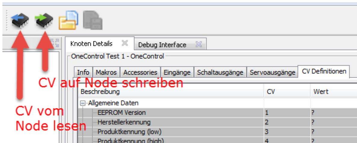
Falls bei einer CV weitere Informationen als Hilfetext hinterlegt sind, werden diese als Tooltip dargestellt.
