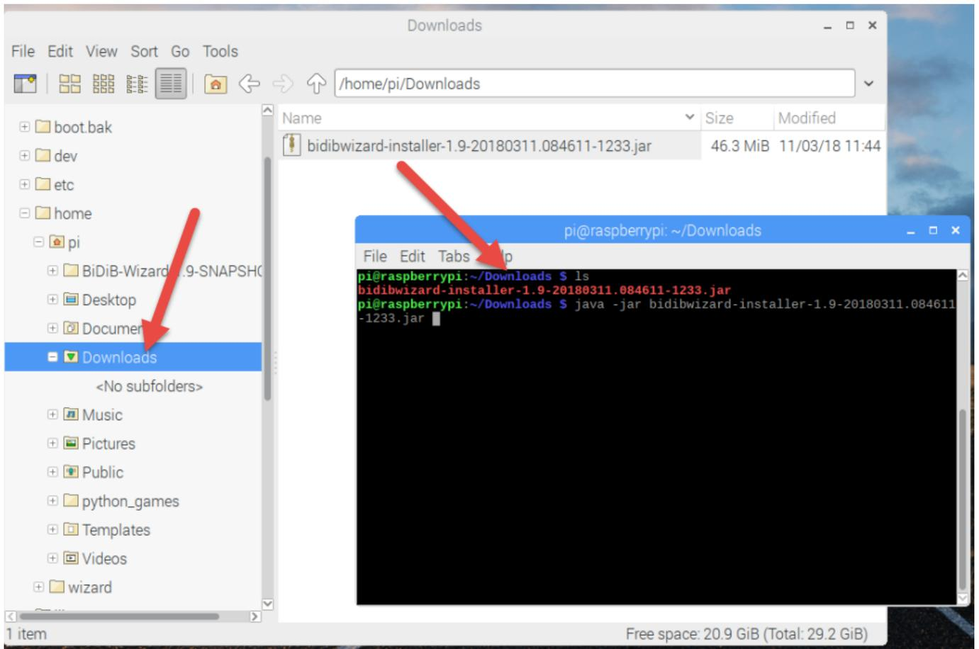
Mit dem Befehl `java -jar bidibwizard-installer-1.9-20180311.084611-1233.jar` kann der Installer für den Wizard gestartet werden. Der Name der Datei `bidibwizard-installer-1.9-...jar` im Beispiel muss an den richtigen angepasst werden.
