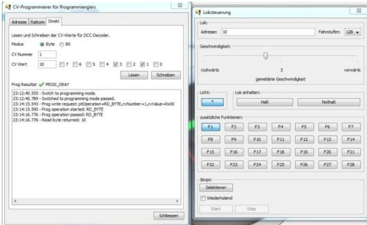
Im BiDiB-Wizard können gleichzeitig mehrere Fenster geöffnet werden. In der Abbildung ist das Fenster **CV-Programmier** und das Fenster **Loksteuerung** geöffnet. Diese doppelte Anzeige ermöglicht das Editieren eines CV-Wertes und das gleichzeitige Testen diese Änderung über die Loksteuerung.
