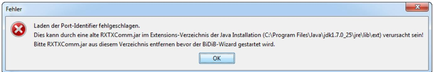
In diesem Fall muss die RXTXComm.jar aus dem angezeigten Verzeichnis entfernt werden damit der Wizard korrekt arbeitet.
