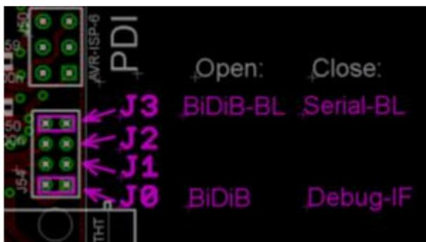
Trennen Sie die USB-Verbindung und DC-Verbindung zum GBMboost Master ab. Die Baugruppe muss vollständig stromlos sein. Stecken Sie jetzt den beiliegenden 2,00mm Jumper aus der Bausatzverpackung, auf den Jumper **J3** auf der 2x 4polige Stiftleiste am GBMboost Master.
