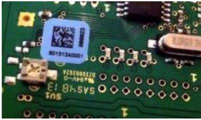
Die aufgeklebte blaue Seriennummer mit einem MatrixCode (ältere Baugruppen hatten einen weißen Aufkleber mit der Bezeichnung S/N) auf der Rückseite der Baugruppe, ist eine Hardware-Seriennummer und hat nichts mit der Unique-ID Seriennummer für die BiDiB-Baugruppen zu tun. **Dieser Aufkleber sollte nicht entfernt werden, weil mit dieser Nummer ist Ihr Baustein bei uns registriert.**
