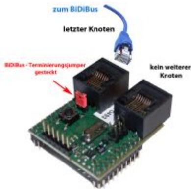
**Hinweis:** Der Jumper darf nur am letzten BiDiB-Knoten im BiDiBus (Anfang und Ende der kompletten Busleitung) gesteckt werden. Besteht der BiDiBus aus einem verzweigten Bus (Stichleitungen) mit Hilfe des BiDiBus Erweiterungsmoduls OneHub, so muss der Bus an allen offenen Enden abgeschlossen werden.
