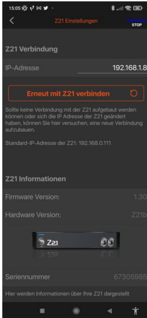
Eine weitere wichtige Option ist die Belegung des Stop-Taster. Dazu in den Z21 Einstellungen nach unten scrollen und bei der Option Stop-Taster der Zentrale den Wert Gleisspannung aus selektieren. Somit können durch Klick auf die Stop-Taste am Bildschirmrand rechts oben die Booster abgeschaltet werden. Ist die Wert Nothalt ausgewählt, wird nur der DCC-Zentrale abgeschaltet.
