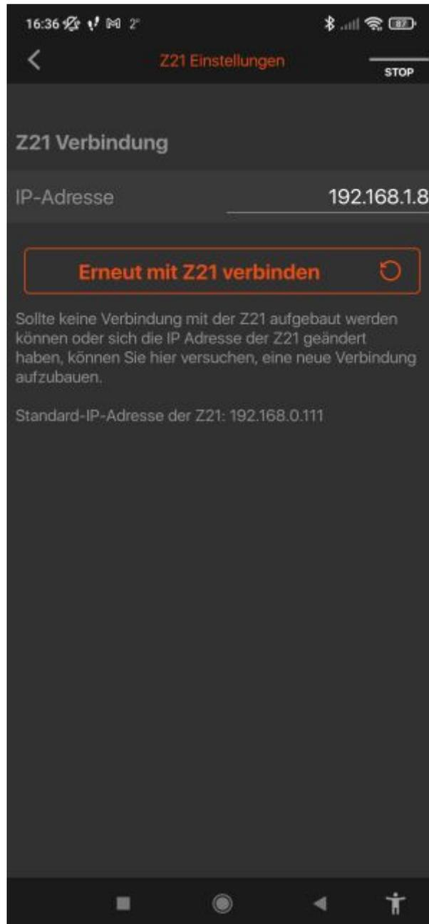
Anschliessend auf den Button Erneut mit Z21 verbinden klicken. Die Z21 App sollte nun mit dem BiDiB-Wizard verbunden sein und Z21 Informationen mit einem Bild der Z21 Zentrale werden angezeigt.
