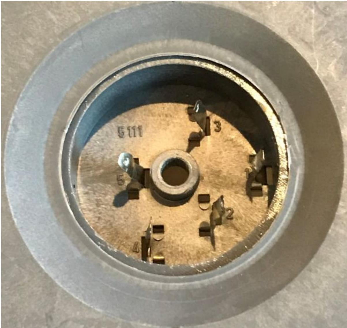
Jetzt löten wir geeignete Kabel an die Anschlüsse. Man kann natürlich auch wieder die gleichen Kabel dort anlöten. Ansonsten sollten die Kabel entweder unterschiedliche Farben haben oder in 2 Gruppen aufgeteilt sein. Diese werden wir später dann auch so durch den Zwischenring fädeln.
