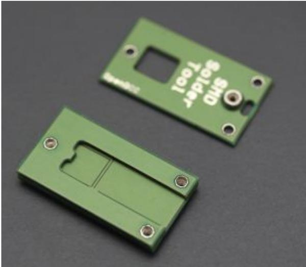
...den Deckel drauf, Schrauben rein, Feder unter die beiden mittleren Schrauben (Schieber und Schraube in der Mitte des Oberteils).
