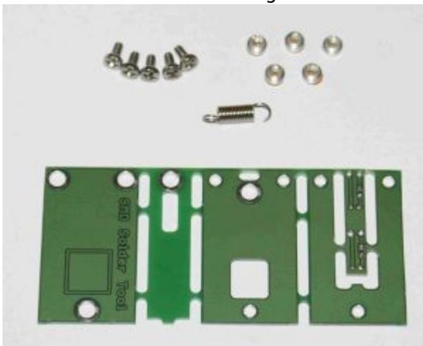
Eine Platine, 5 Einlötmuttern, 5 Schrauben und eine Feder sollten vorhanden sein.
