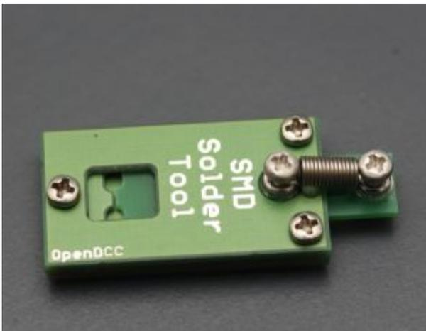
Die mittlere Schraube nur leicht anziehen, da sie sonst den Schieber verklemmt. (Alternativ den Schlitz im Schieber vergrößern.)
