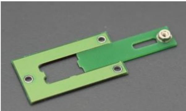
Evtl. auch die Unterseite der Teile abfeilen, wenn sich dort Lötzinn angesammelt hat oder die Muttern etwas rausschauen. Sonst ist nachher ein Leichtlauf, bzw ein Betrieb ohne Wackler nicht möglich.
