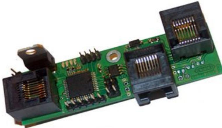
Die **s88-BiDiB-Bridge** ist eine Entwicklung, um s88-Module in das BiDiB-System einzubinden. Sie arbeitet als Brücke (Gateway) zwischen dem BiDiBus und dem s88-Bus.
