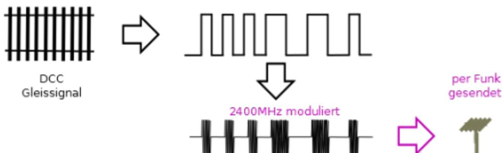
Zum Projektstart stand mit dem DCC-RF-Booster unsere erste Funkbasis für den Betrieb der Fahrzeuge zur Verfügung. Diese ist ein DCC Gleissignal → Funkumsetzer und kann an einer vorhandenen DCC Zentrale oder autonom mit Lenz ©/ Roco © Lokmäusen arbeiten.
