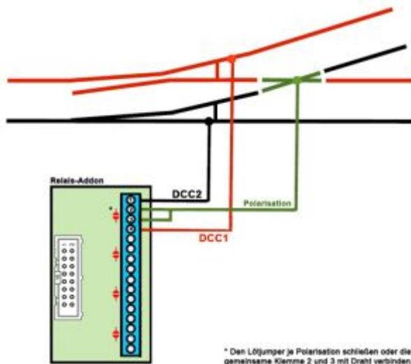
Die beiden mittleren Schraubklemmen 2 und 3 werden mit dem Herzstück der Weiche verbunden, die beiden anderen Kontakte (1 und 4) des RelaisAddons mit den beiden Schienen des Stammgleises. Das RelaisAddon Modul wird mit einem Schaltausgang / Powerausgang eines BiDiB-Devices verbunden (im Beispiel ist das die LightControl) und mit dem BiDiB-Wizard Tool konfiguriert.
