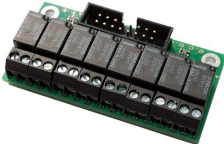
Jedes geschaltete Relais wird mit einer leuchtenden LED signalisiert.
