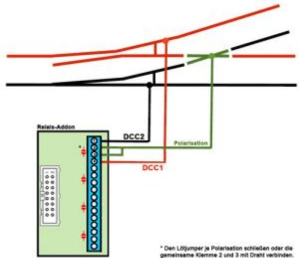
Die beiden mittleren Schraubklemmen 2 und 3 werden mit dem Herzstück der Weiche verbunden. Die beiden anderen Kontakte (1 und 4) des RelaisAddon mit den beiden Schienen des Stammgleises. Das RelaisAddon Modul wird mit einem Schaltausgang / Powerausgang eines BiDiB-Devices verbunden. (in dem Beispiel ist das die LightControl) und mit dem BiDiB-Wizard Tool konfiguriert.
