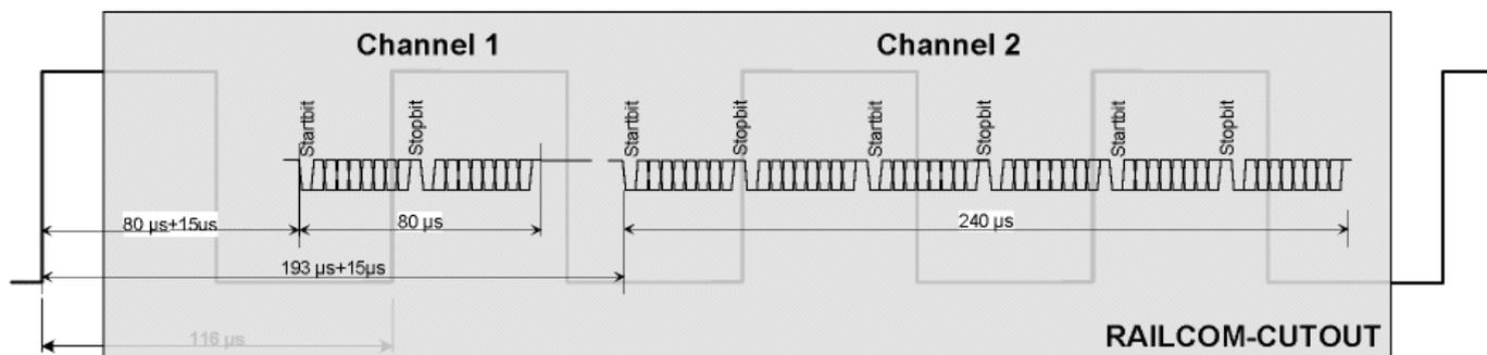
In der CV28 wird (einheitlich bei allen Decodern) festgelegt, ob der Decoder im Channel 1 oder 2 oder in beiden Channel sendet.
