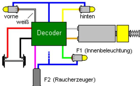
In zahlreichen älteren Loks die noch mit Glühbirnen beleuchtet werden, ist diese Lampe oft einseitig direkt gegen die Schiene geschaltet.
