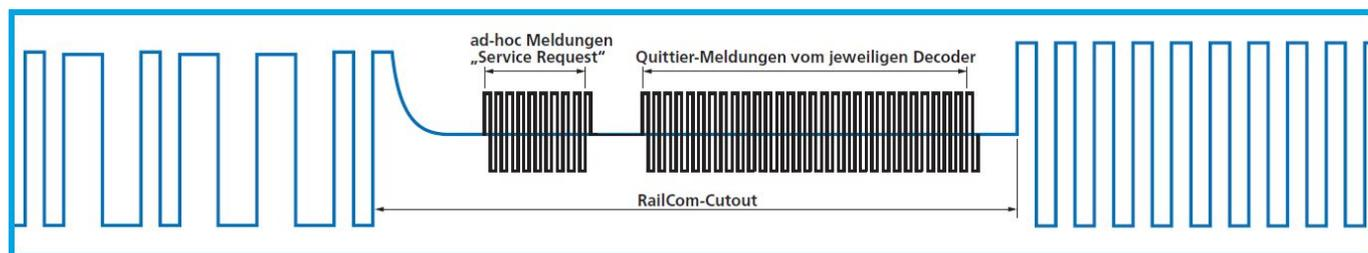
In der Unterbrechungspause darf (und soll!) der Lokdecoder Daten an die Zentrale zurücksenden.
