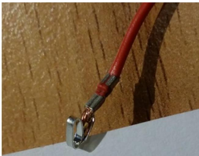
Nun können Sie den Kontakt entsprechend der Codierung in das Gehäuse einstecken. Dies ist meist problemlos möglich und Sie hören ein leichtes Einrasten. Sollte bei einem Kabel das Einrasten nicht zu hören sein, kann man auch mit einem Stück 0,8 oder 1mm starken Stahldraht vorsichtig von oben nachhelfen. Der Kontakt, sollte jetzt fest im Gehäuse sitzen und sich nicht mehr rausziehen lassen.
