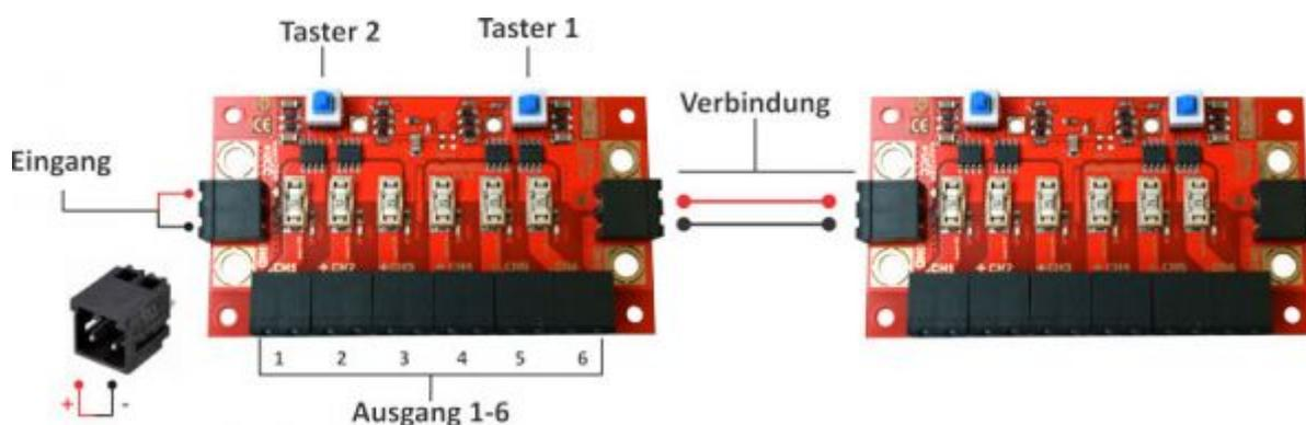
Keinesfalls darf nur die Plusleitung vom Powerboard genommen und die Minusleitung über mehrere Baugruppen durchgeschliffen werden!
