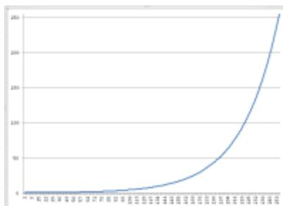
Mit der CV 1135 kann die Helligkeitszuordnung angepasst werden, es gibt die Auswahl zwischen der gezeigten Gamma-Kurve und einer Linearen (1:1).
