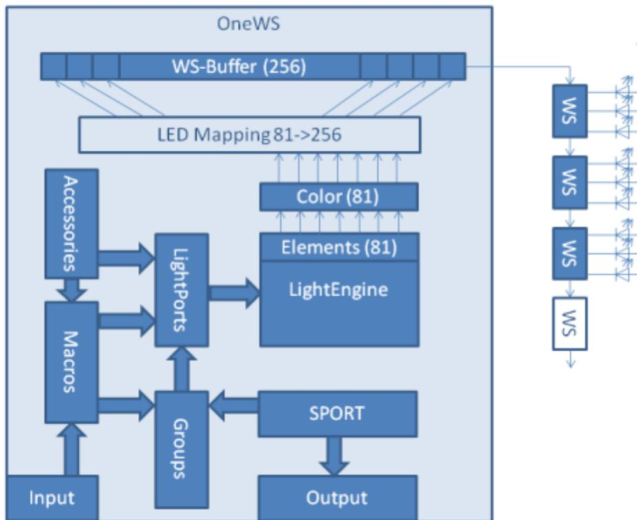
Das zentrale Element ist die LightEngine. Sie entspricht der LightEngine aus der LightControl und bietet damit die bekannten Fähigkeiten zur Steuerung der LightEngine Elemente (LEE): Helligkeit, Dimmen, Blinken, etc.
