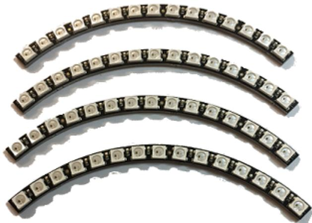
Für die Zeitanzeige werden 60 x WS2812 in einem Kreis angeordnet.
