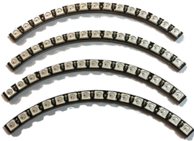
Für die Zeitanzeige werden 60 x WS2812 in einem Kreis angeordnet.
