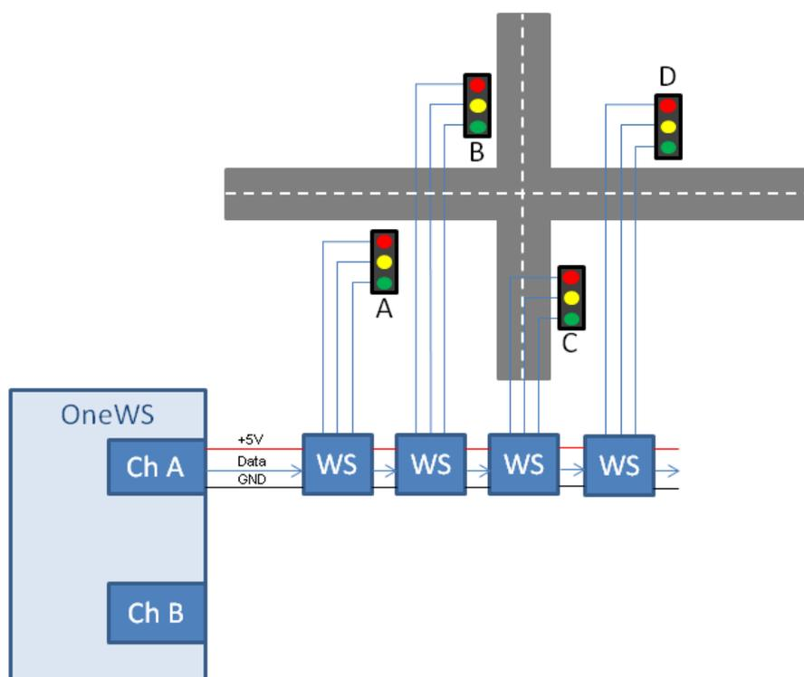
Die Ampeln A und D sowie B und C werden identisch geschaltet. Somit müssen 6 LEDs gesteuert werden, diese sind hier wie im Bild gezeigt an den Positionen 0 bis 5. Das Accessory 0 mit den Lightports 10 bis 15 soll verwendet werden. Zunächst wird die Grundkonfiguration für das Accessory festgelegt:
