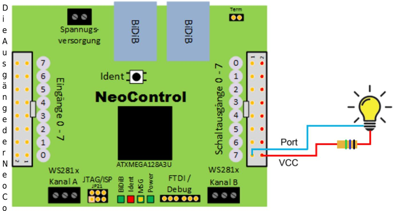
Die Ausgänge der NeoControl entsprechen denen der LightControl und bieten somit die gleichen Anschlussmöglichkeiten (siehe hier [Lightcontrol Power-Ausgänge](#))
