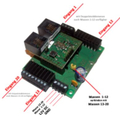
Der Knoten OneOC kann mit Hilfe von Tastern, Schaltern, Reed-Kontakten, Lichtschranken oder Hallensensoren Ereignisse über den BiDiBus an ein PC-Steuerprogramm melden ([Beispiele](#)).
