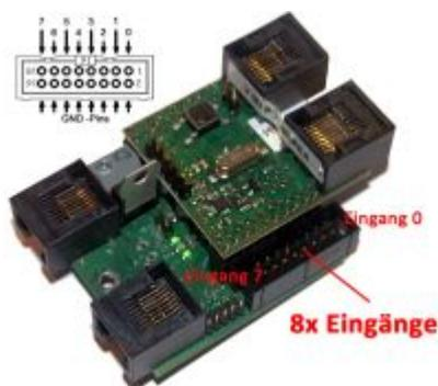
Der OneIF stellt dem Anwender acht Eingänge zur Ereignisabfrage oder zur Steuerung von Abläufen bereit. In der Abbildung ist die Pinbelegung der 8 massebezogenen Eingänge ersichtlich. Mit Tastern, Schaltern, Reed-Kontakte, Lichtschranken oder Hallensensoren kann gegen einen Massebezug an das Hostprogramm Ereignisse gemeldet werden.
