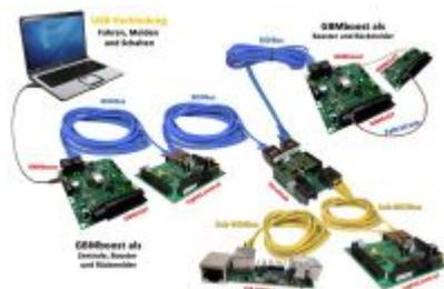
**Erklärung:** Die Verbindung zum PC übernimmt ein Interface (z.B. der GBMboost Master), welches innerhalb der Modellbahn das Bussystem BiDiBus aufspannt. An diesem Bussystem können bis zu 32 Knoten (BiDiB-Baugruppen) angeschlossen werden (blaues RJ45-Kabel in der Abbildung). Wenn diese Knotenanzahl nicht ausreicht oder auf Grund der Anlagenstruktur ein weitere Ebene benötigt wird, dann kann mit dem OneHub eine weitere Ebene hinzugefügt werden. Mit der neuen zusätzlichen
