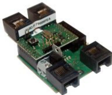
Die **Applikation „OneHub“** besteht aus zwei Baugruppen: Aufsteckmodul **BiDiBone** und Addon-Modul **OneIF**. Das **OneHub** ist eine Buserweiterung für den BiDiBus.
