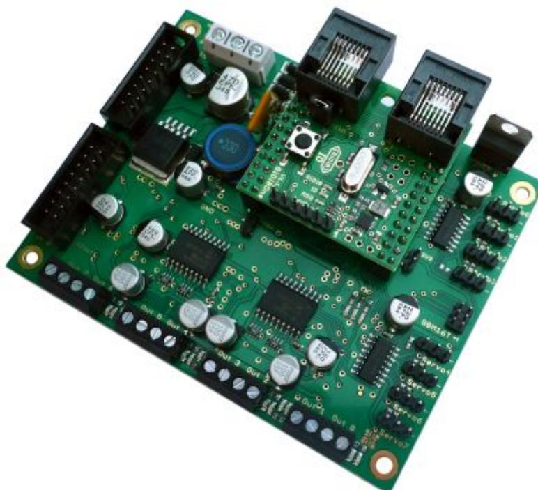
Der **OneDriveTurn Baustein** besteht aus zwei Komponenten: **BiDiBOne** und **OneDriveTurn**.
