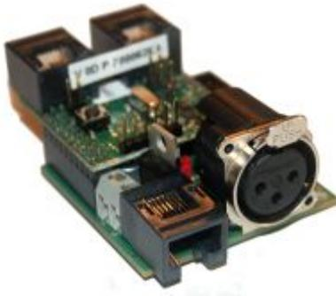
Der OpenDCC **OneDMX Baustein** besteht aus zwei Komponenten: **BiDiBOne** und **OnelF**. Diese beiden Teile können zusammen mit der passenden Firmware „**OneDMX**“ als BiDiBus - DMX Interface für DMX512 Devices verwendet werden.
