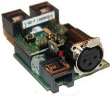
Der OpenDCC **OneDMX Baustein** besteht aus zwei Komponenten: **BiDiBOne** und **OneIF**. Diese beiden Teile können zusammen mit der passenden Firmware „**OneDMX**“ als BiDiBus - DMX Interface für DMX512 Devices verwendet werden.
