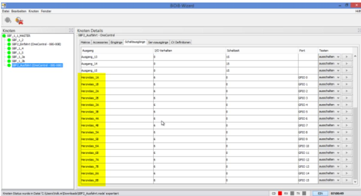
Nun richten wir die Makros ein. Pro Weiche sind zwei Makros nötig. Um eine klare Linie zu halten, nehmen wir das erste Makro für die Stellung **gerade** und das zweite Makro für **abzweig**. Je nach Einbaulage der Servos und Verdrahtung der Relais ist das passende Relais am Ende des Makros einzuschalten. Die Makros sind für die bessere Übersicht umbenannt worden.
