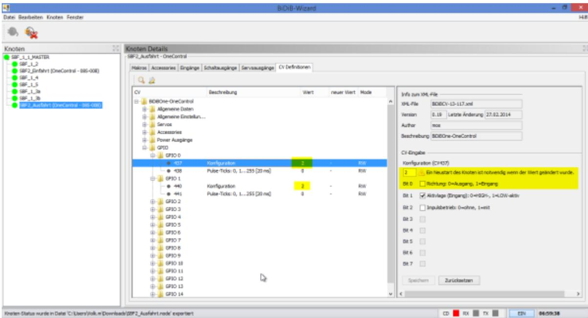
Nach dem Neustart der OneControl erscheinen die GPIO´s unter Schaltausgänge und können umbenannt werden:
