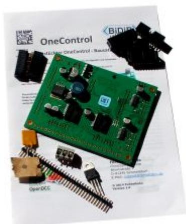
Beim SMD bestückten Bausatz (SMD-Bausatz) der OneControl sind alle notwendigen SMD-Bauteile für alle Hardwarefunktionen vorbestückt.
