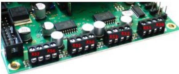
Die Motorausgänge des **OneDriveTurns** können mit maximal 500mA Dauerstrom je Ausgang belastet werden. Ein kurzzeitiger Peakstrom bis 1,2A ist zulässig.
