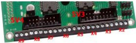
Jeder einzelner Powerausgang der **OneControl** verträgt einen Dauerstrom von 1A und kann kurzzeitig mit bis zu 1,5A (Puls) belastet werden. Die Eignung eines Magnetartikels u.A. für die OneControl kann im Kapitel [Magnetartikel](#) nachgelesen werden.
