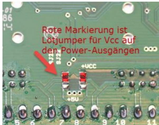
Durch Schliessen der blauen Markierung werden die Powerausgänge mit 5V versorgt.
