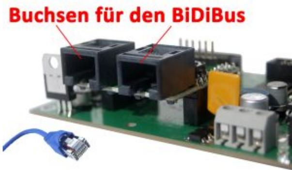
Das [Aufsteckmodul BiDiBone](#) ist das Herz der Baugruppe und stellt die Verbindung zum BiDiBus her. Mit dessen beiden RJ45-Buchsen wird die Baugruppe an den BiDiBus angeschlossen.
