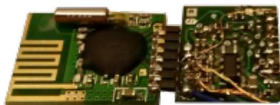
Ein Nachteil dieser Module ist die 7-polige Verbindung, welche zu ihrem Betrieb am Cardecoder nötig ist. Aus diesem Grund sind die Anschluss pads auf der Cardecoder Platine an die Belegung und Platzierung der Anschlüsse auf dem Funkmodul angepasst. So dass eine vertretbare Montage „Huckepack“ oder gegenüberliegend in einer Reihe mit Hilfe einer 7-poligen Stiftleiste im Raster 1,27 mm möglich ist.
