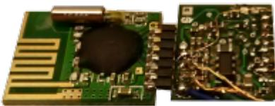
Ein Nachteil dieser Module ist die 7 polige Verbindung, welche zu ihrem Betrieb am Cardecoder nötig ist. Aus diesem Grund sind die Anschluss pads auf der Cardecoder Platine an die Belegung und Platzierung der Anschlüsse auf dem Funkmodul angepasst. So das eine vertretbare Montage „Huckepack“ oder gegenüberliegend in einer Reihe mit Hilfe einer 7 poligen Stifteleiste im Raster 1,27 mm möglich ist.
