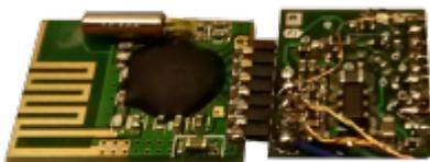
Ein Nachteil dieser Module ist die 7 polige Verbindung, welche zu ihrem Betrieb am Cardecoder nötig ist. Aus diesem Grund sind die Anschluss pads auf der Cardecoder Platine an die Belegung und Platzierung der Anschlüsse auf dem Funkmodul angepasst. So das eine vertretbare Montage „Huckepack“ oder gegenüberliegend in einer Reihe mit Hilfe einer 7 poligen Stiftleiste im Raster 1,27 mm möglich ist.
