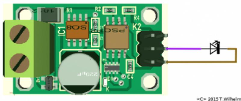
Werden zwei IR Dioden genutzt (z.B. für jede Fahrtrichtung eine), sollten diese in Reihe angeschlossen werden.
