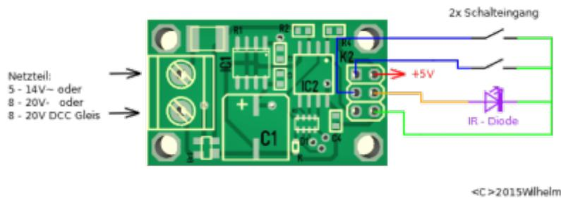
An K1 auf der linken Seite vom IRM wird die Betriebsspannung angeschlossen. Dabei braucht man nicht auf die Anschlusspolarität achten. Auf der rechten Seite, an die sechs-polige Stiftleiste K2, wird die IR Diode und bis zu zwei Schaltkontakte angeschlossen. Mit diesen kann man unterschiedliche IR Telegramme auswählen. Anstelle dieser „Schalter“ können auch Reedkontakte oder Magnetsensoren genutzt werden. Für diese steht eine 5V Betriebsspannung zur Verfügung (rot +5V / grün GND).
