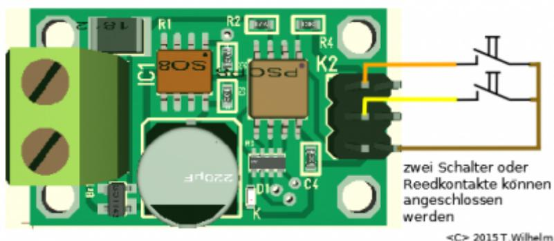
Es kann auch ein Schaltausgang (welcher nach GND schaltet) einer anderen BiDiB Baugruppe z.B. der LightControl verwendet werden.
