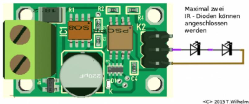
Der zum Betrieb der IR Dioden nötige Vorwiderstand ist auf dem IRM schon integriert. Es sind somit keine weiteren externen Bauteile nötig.
