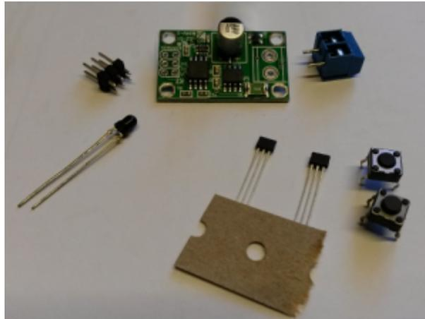
Das IRM ist als SMD bestückte Platine im Fichtelbahn Shop erhältlich. Auf der Platine selbst kann noch eine zweipolige Schraubklemme und eine sechspolige (2×3) Stiftleiste montiert werden. Die Schraubklemme dient zum Anschluss der Betriebsspannung, an der Stiftleiste wird die IR Diode zum senden und bis zu zwei Schalter oder Magnetschalter (Sensoren z.B. TLE4605) zum wählen von unterschiedlichen Funktionen angeschlossen.
