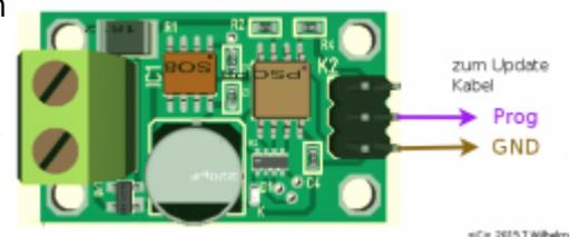
**Achtung**, sollte versehentlich CV32 umprogrammiert worden sein, oder die gleiche Softwareversion wieder programmiert worden sein, startet das IRM nicht mehr! Das IRM muss dann eingeschaltet ca. **120 Sekunden** stehen gelassen werden, danach verlässt es von selbst den Update Modus und schaltet in den Normalbetrieb zurück.
