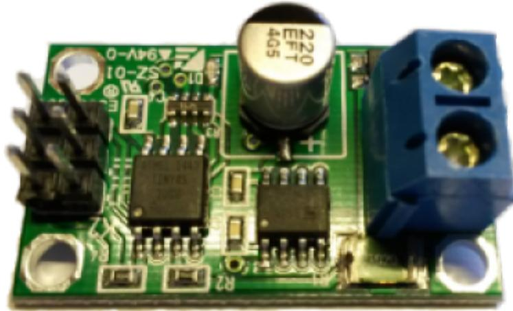
Das OpenCarSystem Infrarot Modul (IRM) ist eine kleines Modul zur lokalen Beeinflussung von Modellbahn Straßenfahrzeugen. Es kann DCC IR Steuersignale selbstständig erzeugen und so Funktionen oder Rückmeldungen in einem Straßenfahrzeug mit einem OpenCarSystem Cardecoder schalten bzw. auslösen.
