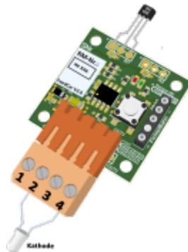
**2-Kanal IR Position Rückmelder:** FeedCar sendet für eine einstellbare Anzahl von Wiederholungen eine von zwei unterschiedlichen Positionsadressen in Abhängigkeit vom auslösenden SS49E Sensor.
