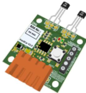
**1-Kanal IR Position Rückmelder:** FeedCar sendet permanent seine Positionsadresse als DCC IR Nachricht. Jedes vorbeifahrende Fahrzeug kann damit seine aktuelle Position auf der Modellbahn melden.
