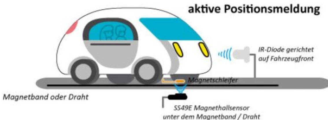
Die Fahrzeugerkennung erfolgt mit Hilfe von hoch empfindlichen SS49E Magnetfeld Sensoren, welche unter der Strasse montiert werden. Die vom FeedCar aufbereitete Belegungsinformation lässt sich in andere „Input“ Baugruppen (z.B. [S88-TLE-Interface](#)) einlesen und zur Steuerung des Fahrbetrieb nutzen.
