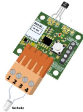
**2-Kanal IR Funktionssender:** Es können zwei von 28 DCC Funktionen in Abhängigkeit vom auslösenden Eingang gesendet werden.
