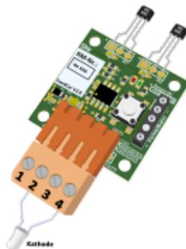
**1-Kanal IR Funktionssender:** Es wird permanent eine von 28 DCC Funktionen als DCC IR Nachricht gesendet.
