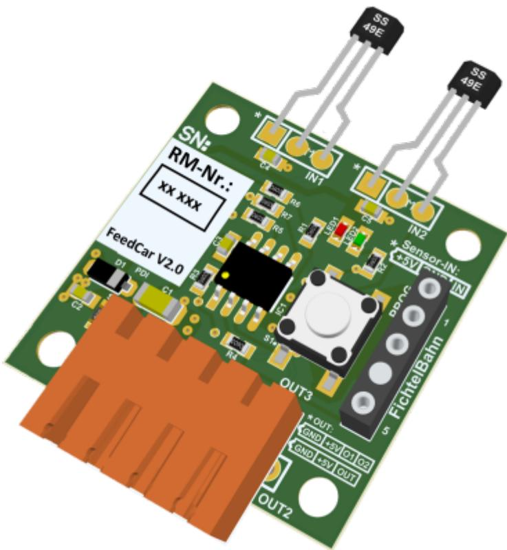
**1-Kanal IR Position Rückmelder:** FeedCar sendet permanent seine Positionsadresse als DCC IR Nachricht. Jedes vorbeifahrende Fahrzeug kann damit seine aktuelle Position auf der Modellbahn
