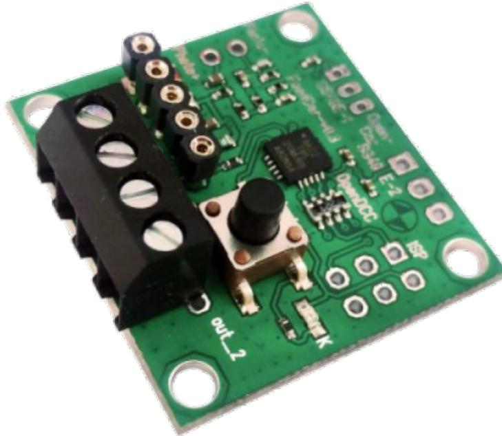
Das FeedCar (Car Feedback) ist eine kleine Baugruppe zum Rückmelden von Fahrzeug Positionsdaten und Senden von DCC IR Steuersignalen. Hiermit lassen sich Funktionen lokal schalten oder Positionsrückmeldungen in einem Straßenfahrzeug mit einem OpenCar-System Cardecoder auslösen. Es ersetzt das [IRM](#) komplett. Die Programmierung erfolgt mit der Taste auf der Baugruppe oder per externem Tool (= OpenCar-Updatekabel notwendig)
