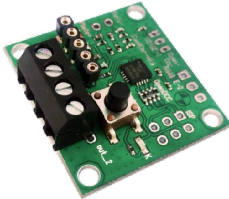
Das FeedCar (Car Feedback) ist eine kleine Baugruppe zum Rückmelden von Fahrzeug Positionsdaten und Senden von DCC IR Steuersignalen. Hiermit lassen sich Funktionen lokal schalten oder Positionsrückmeldungen in einem Straßenfahrzeug mit einem OpenCar-System Cardecoder auslösen. Es ersetzt das [IRM](#) komplett. Die Programmierung erfolgt per externem Tool.
