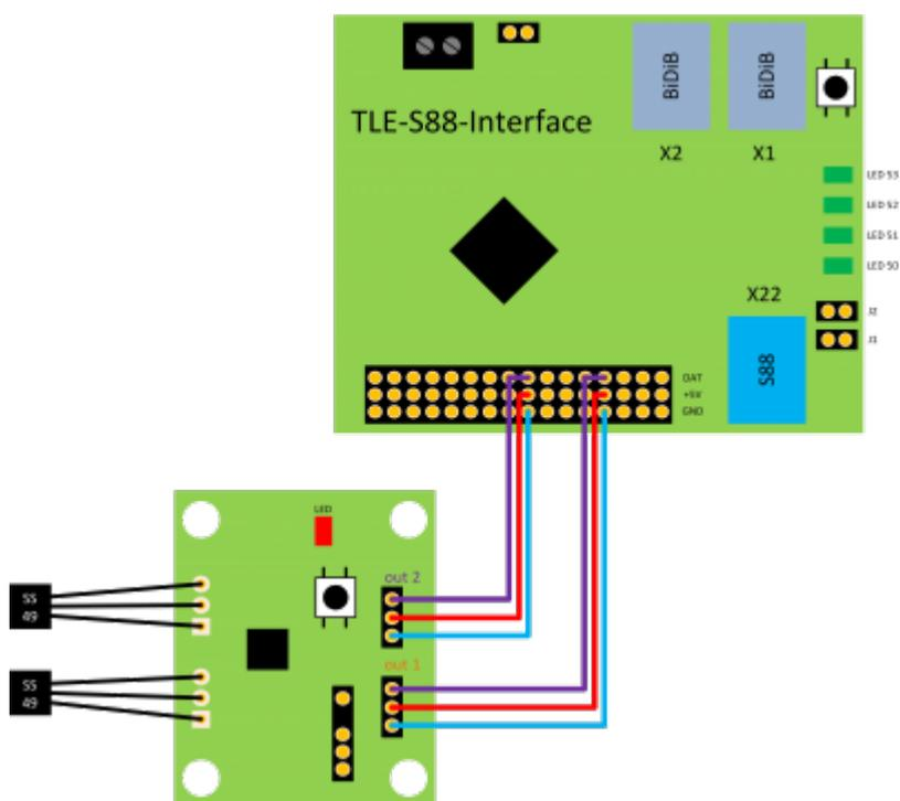
Wichtig ist dabei, dass die Verbindung zum Ausgang **out1** auf dem FeedCar immer verbunden ist. Falls nur Ausgang **out2** verbunden ist, hat das FeedCar keine Spannung.
