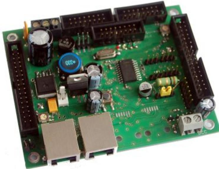
Die LightControl ist ausgestattet mit einem DCC-Interface und mit einem BiDiB-Interface für eine schnellere, sichere und adresslose Kommunikation. Durch eine frei wählbare Portzuweisung (Ausgänge) mit Hilfe des BiDiB-Wizards kann Ihre Anlage zu jederzeit um einen weiteren Effekt erweitert werden.
