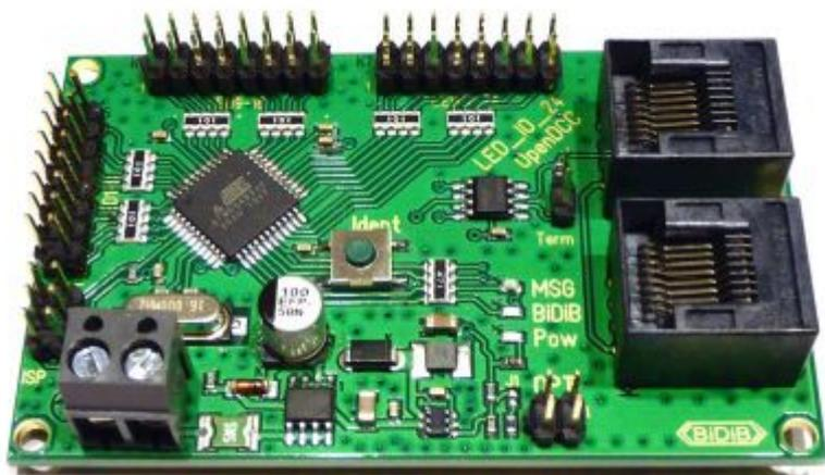
Die **LED\_IO\_24** ist eine Weiterentwicklung des MoBaList. Die LED\_IO\_24 ist ausgestattet mit einem BiDiB-Interface und besitzt 24 Ausgänge/Eingänge, die frei über das BiDiB-Wizard Tool konfiguriert werden können. Die 24 Ausgänge/Eingänge erlauben den Anschluss von LEDs für Beleuchtungsaufgaben. Als Eingang konfiguriert können sie als Eingänge verwendet werden oder als Belegtmelder konfiguriert werden.
