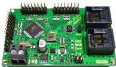
Die **LED\_IO\_24** ist eine Weiterentwicklung der MoBaList. Die LED\_IO\_24 ist ausgestattet mit einem BiDiB-Interface und besitzt 24 Ausgänge/Eingänge, die frei über das BiDiB-Wizard Tool konfiguriert werden können. Die 24 Ausgänge/Eingänge erlauben den Anschluss von LEDs für Beleuchtungsaufgaben. Als Eingang konfiguriert können sie als Eingänge verwendet werden oder als Belegtmelder konfiguriert werden.
