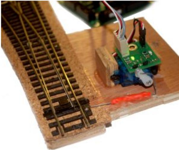
Die **LCsensor-Platine** kann unterschiedlich bestückt werden. Die Abbildung zeigt eine Variante mit 2 Hallensensoren für die Erkennung der Servostellung an einem Weichenantrieb. Damit kann dem PC-Programm gemeldet werden, dass der Servo x die Position Y erreicht hat.
