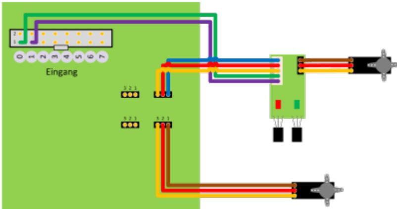
Über die 5-polige Flachbandleitung wird auch der Servoantrieb versorgt und gesteuert.
