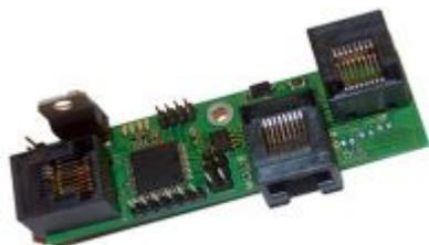
Die **s88-BiDiB Bridge** war die erste Baugruppe für diese Zwecke und wurde durch den Bausatz TLE-s88-BiDiB Interface abgelöst. Die s88-BiDiB Bridge wird trotzdem weitergepflegt und Sie erhalten weiterhin im Fichtelbahn-Shop die notwendige Platine für den Aufbau. Es wurde jeglich der verfügbare Löt-Bausatz eingestellt. Die notwendigen Bauteile können mit Hilfe des Reichelt-Warenkorb bzw. mit der veröffentlichten Stückliste bei Elektronikversandanbietern erworben werden.
