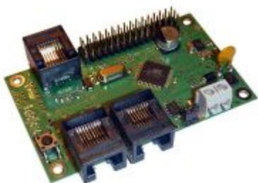
Die SMD-vorbestückte **TLE-s88-BiDiB Bridge** ist ein vorbestückter Bausatz, bei dem nur noch die Stiftleisten aufgelötet werden müssen. Diese Baugruppe ist im Fichtelbahn-Shop nur in dieser Variante verfügbar, es gibt hier keinen Löt-Bausatz. Dieser BiDiB-Knoten hat neben der s88-Integration noch weitere 16 TLE-Eingänge auf der Baugruppe verbaut. Unter TLE versteht man ein uni- und bipolar Hall IC, für magnetische Feld-Anwendungen - kurz „Hallsensor“.
