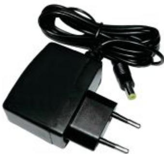
Die 5V Hilfsspannung **muss** unbedingt von einem separaten Netzteil erfolgen. Sie darf in keinem Falle das gleiche Massepotenzial wie die GBMboost-Versorgungsspannung haben! Mit einem 5V Steckernetzteil aus dem Handy- bzw. Consumer-Bereich ist diese Anforderung erfüllt. Ein Steckernetzteil mit 500mA Ausgangstrom genügt für diese Anwendung.
