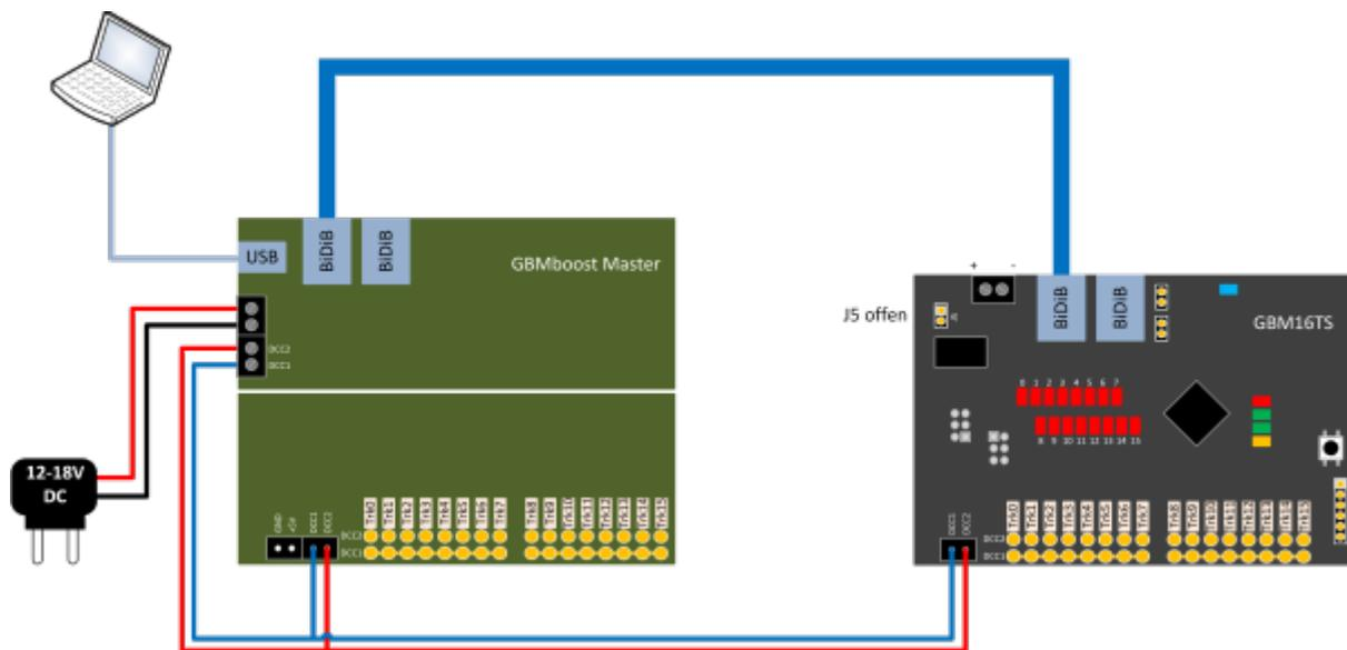
Der GBM16TS benötigt nur eine Verbindung zum BiDiBus mit Hilfe eines RJ45-Patchkabel. Über den BiDiBus erhält die Baugruppe ihre eigene Spannungsversorgung und die vollständige Kommunikation mit den Rückmeldedaten. Von einem DCC-Booster (z.B. GBMboost) wird der DCC-Fahrstrom (hellblau und rote Leitung) mit dem DCC-Eingang (DCC1 u. DCC2) vom GBM16TS verbunden. Befindet sich die Baugruppe am Busende bzw. Busanfang, müssen noch die beiden Terminierungsjumper J2 und J3 geschlossen werden.
