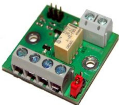
Mit Hilfe der Relaisplatine „ProgSchalt“ kann das angeschlossene Gleis zwischen Fahrbetrieb (normalen GBM16T-Ausgang) und dem Programmiergleis (von einem weiteren GBMboost Master) umgeschaltet werden. Damit lässt sich im fahrenden Anlagenbetrieb auf dem Programmiergleis über den zweiten GBMboost Master eine Lok programmieren. Der normale Anlagenbetrieb ist bei dieser Variante nicht betroffen und kann fortgesetzt werden.
