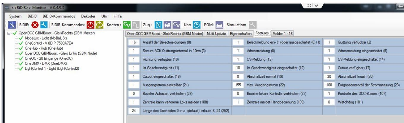
Im Feld **maximaler Ausgangsstrom** (FEATURE\_BST\_AMPERE), steht der Defaultwert 155 und bedeutet 3A.
