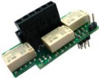
Der GBM16TS (16fach-Belegtmelder) hat die Möglichkeit, ein Kehrschleifenmodul aufzunehmen. Mit dieser Zusatzplatine bekommt die Hardware ohne weiterer Elektronik eine automatische Kehrschleife.
