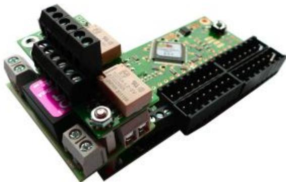
Das GBM\_DC/DC Modul kann alleine oder zusammen mit einem Kehrschleifenmodul auf einem GBM16T montiert werden. Die notwendigen Stiftheisen, Buchsenleisten und Stapelleisten sind im Reichelt-Warenkorb vorhanden. Mit Hilfe von Abstandshaltern und Bohrungen in der Platine, wird eine stabile Montage gewährleistet.
