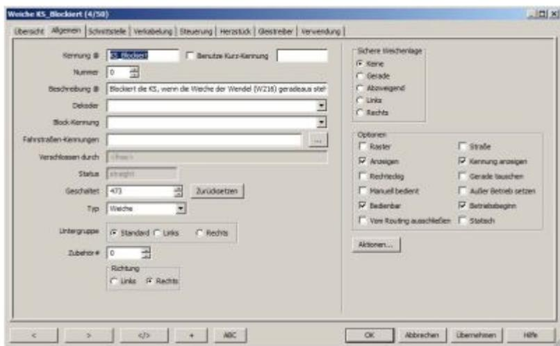
2.) Im Reiter Schnittstelle. Dort folgendes ausfüllen: Schnittstellenkennung: vom GBMBoost Master, Bus: Kennung des Masters (Programmieren ⇒ BidiB ⇒ Booster ⇒ eindeutige Kennung am Bus, rechtes Feld, nur mit Ziffern), Protokoll NMRA-DCC, Adresse: 201 (oder die dafür vorgesehene DCC Adresse), Haken bei „Zubehör“ setzen.
