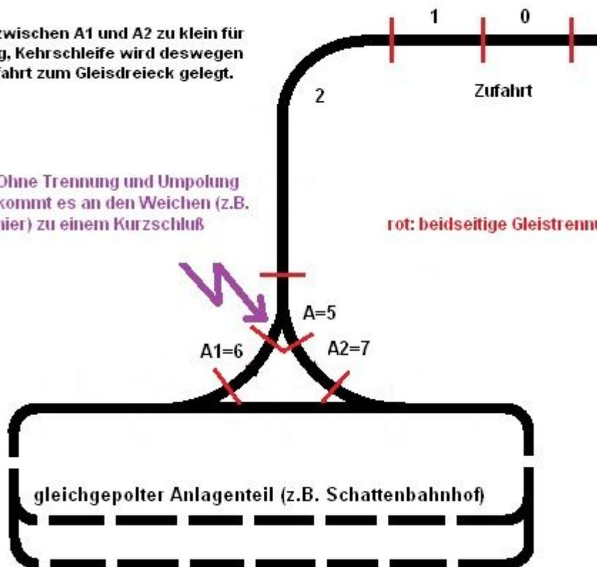
Konfiguration für den GBM, Die Weiche schaltet in diesem Beispiel auf DCC Adresse 102 (z.B. mit einem Decoder2)
