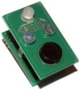
An den GBMboost (Master/Node) kann ein Notaustaster angeschlossen werden. Der Anschluss erfolgt an der Stiftklemme J2 auf der GBMboost Platine.
