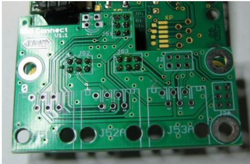
Zu bestücken sind J51, J52 und J53. Achtung: J51 ist der oben quer liegende Verbinder! Möchte man auch den Notaus-Taster über ein RJ12 Kabel führen, so sind auch J2 und J2A zu bestücken, genau so wie die anderen Buchsenleisten. Danach kommen die drei RJ12 Buchsen dran. Diese von oben durch die Platine stecken und festdrücken, bis die Plastiknasen einrasten. Dann kann man sie bequem festlöten.
