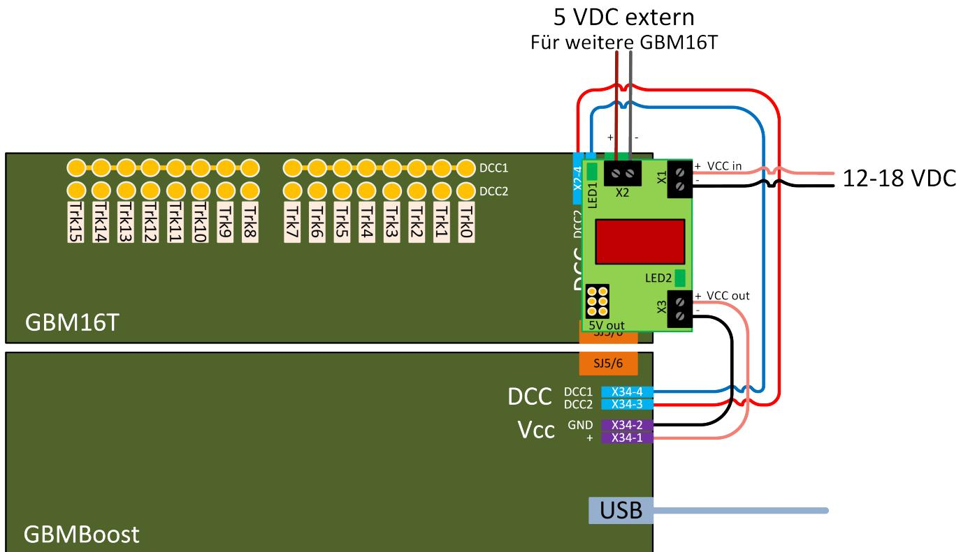
Der Huckepack - GBM16T erhält über die interne 6-polige Stiftleiste seine 5V Hilfsspannung. Müssen weitere GBM16T Module (die mit dem gleichen Booster verbunden sind) mit einer 5V Hilfsspannung versorgt werden, kann diese Versorgung über die dritte Klemme X2 abgegriffen werden.
