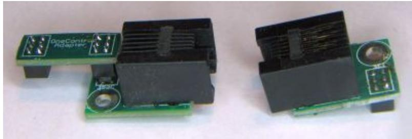
RJ12 Verbindungskabel gibt es in der passenden Länge leider nicht bei Reichelt. Man kann sie entweder selbst crimpeln oder in diversen Längen im Internet bestellen (z.B. Amazon, Ebay, Aliexpress,...), wichtig ist, daß das Kabel 6 polig belegt ist. Am besten sucht man nach: **RJ12 6P6C**
