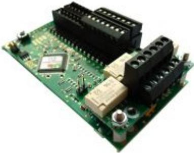
Die Besonderheit ist, dass das Kehrschleifenmodul nicht nur als klassische Kehrschleife mit Sensorgleisen (ON-/OFF-Melder) und Schalten über einen DCC-Befehl funktioniert.
