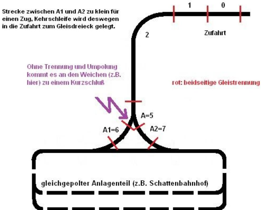
Konfiguration für den GBM, Die Weiche schaltet in diesem Beispiel auf DCC Adresse 102 (z.B. mit einem Decoder2)
