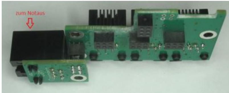
Die OneControl Adapterplatine bekommt 2 Stück 2x3er Buchsenleisten von unten durch die Platine gesteckt und auf der Oberseite verlötet, dann kann sie einfach auf OneControl und kleine Platine wie eine Brücke aufgesteckt werden.
