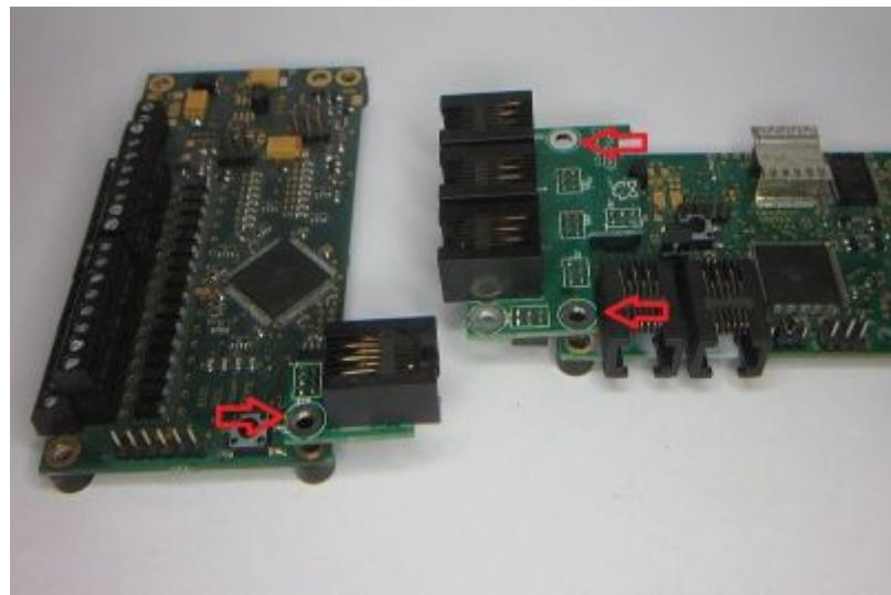
Anmerkung: Wird der GBM-Connect auf einem GBMBoost-Master Variante 2 (externe Einspeisung des DCC Signals) benutzt, so muß man die große Platine im Bereich der Anschlußklemme für das externe DCC Signal etwas ausschneiden. Obwohl die Leiterbahnen ein Stück von der betroffenen Stelle entfernt sind sollte man trotzdem vorsichtig vorgehen, nicht daß man abrutscht und evtl. eine der Leiterbahnen zerkratzt.
