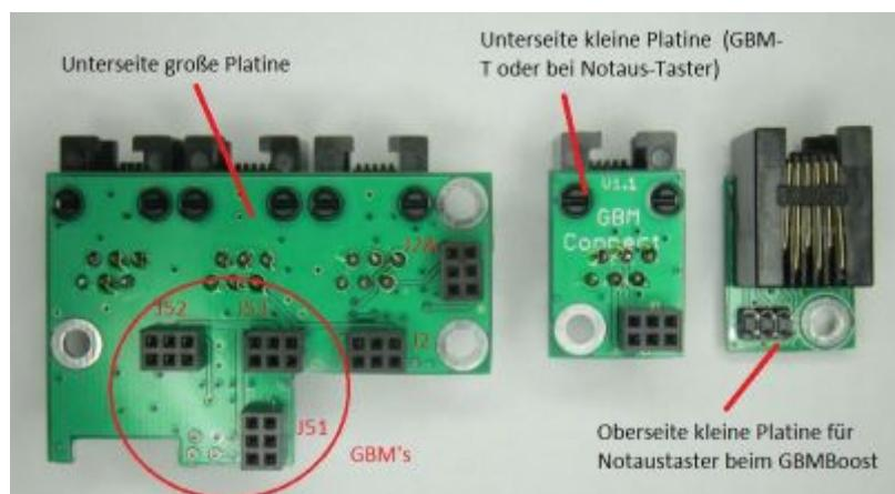
Bei den drei GBM-T Platinen am besten erst die 2x3-polige Buchsenleiste von unten durch die Platine stecken und oben festlöten, dann umdrehen und die RJ12 Buchse durchstecken und festlöten. Die kleine Platine auf Seiten des Notaus Tasters wird identisch bestückt.
