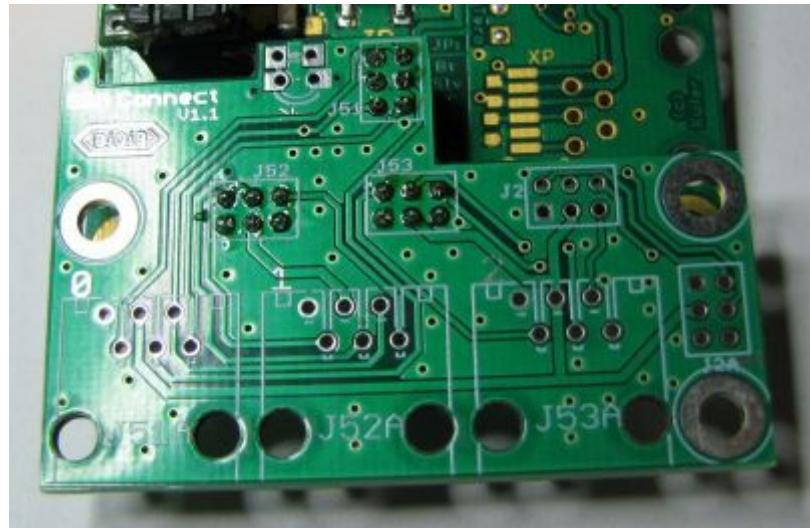
Zu bestücken sind J51, J52 und J53. Achtung: J51 ist der oben quer liegende Verbinder! Möchte man auch den Notaus-Taster über ein RJ12 Kabel führen, so sind auch J2 und J2A zu bestücken, genau so wie die anderen Buchsenleisten. Danach kommen die drei RJ12 Buchsen dran. Diese von oben durch die Platine stecken und festdrücken, bis die Plastiknasen einrasten. Dann kann man sie bequem festlöten.
