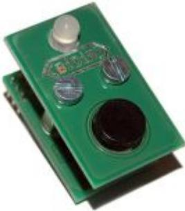
An den GBMboost (Master/Node) kann ein Notauastaster angeschlossen werden. Der Anschluss erfolgt an der Stiftklemme J2 auf der GBMboost Platine.
