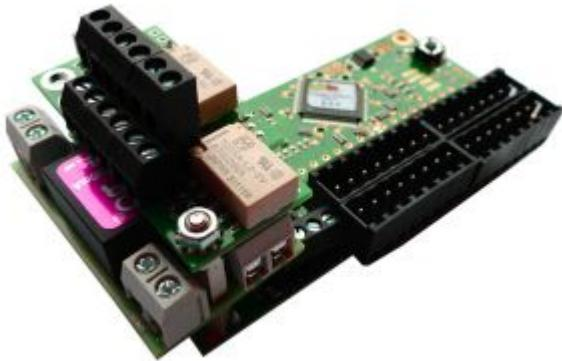
Das GBM\_DC/DC Modul kann alleine oder zusammen mit einem Kehrschleifenmodul auf einem GBM16T montiert werden. Die notwendigen Stiftleisten, Buchsenleisten und Stapelleisten sind im Reichelt-Warenkorb vorhanden. Mit Hilfe von Abstandshaltern und Bohrungen in der Platine, wird eine stabile Montage gewährleistet.
