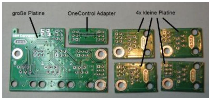
Die Bauteile sind alle bei Reichelt Elektronik erhältlich und müssen selbst bestückt werden. Die große Platine hat eine Betriebsspannungsanzeige per LED. Wurde die große Platine korrekt auf den GBMBoost gesteckt und ist dessen 3,3V Versorgung vorhanden, so leuchtet die LED. Man kann statt den SMD Bauteilen (Baugröße 1206), die im Reichelt Warenkorb vorhanden sind auch auch
