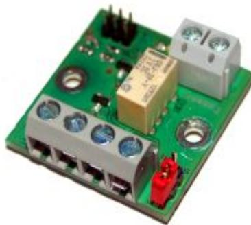
Der GBMboost Master verfügt ab der Firmware 2.1.0 die Funktion des Programmiergleis (PT). Das Programmiergleis kann in drei Varianten mit dem GBMboost Master realisiert werden: Standalone Programmer (eigener GBMboost Master), Wechselbetrieb (zwei GBMboost Masters + ProgSchalt Modul) und Mischbetrieb (ein GBMboost Master für Fahrbetrieb und Programmiergleis). Weitere Angaben zu diesen Varianten finden Sie [hier](#).
