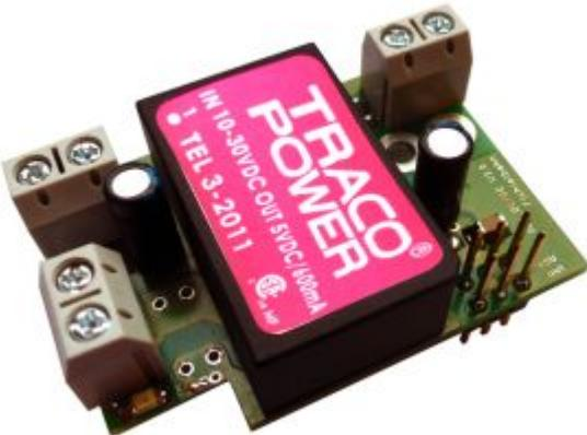
**Die Vorteile** einer 5V-Hilfsspannung sind, dass auch noch im Kurzschlussfall bzw. bei abgeschaltetem Booster, eine lückenlose Gleisüberwachung der Abschnitte möglich ist.
