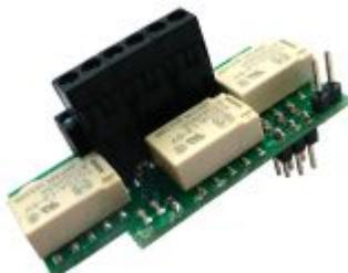
Der GBM16T (16fach-Belegtmelder) vom GBM hat die Möglichkeit, ein Kehrschleifenmodul aufzunehmen. Mit dieser Zusatzplatine bekommt die Hardware ohne weiterer Elektronik eine automatische Kehrschleife.
